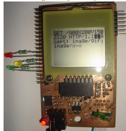
Figura 7. Circuitul de interfata – afisand sirul de caractere receptionat prin TCP
