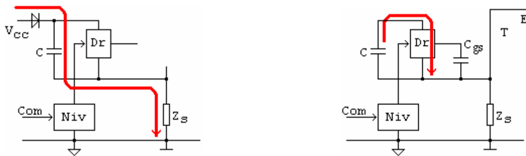
Figura 3: Circuit echivalent, pe durata Toff (încărcarea C) și durata Ton (descărcarea C)
