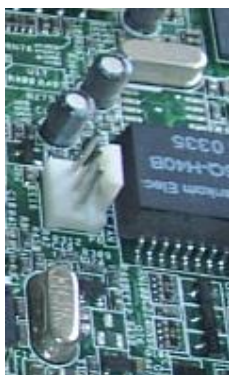
Figura 33: Două capsule de rezonator piezoelectric, pe placa de bază a unui calculator
