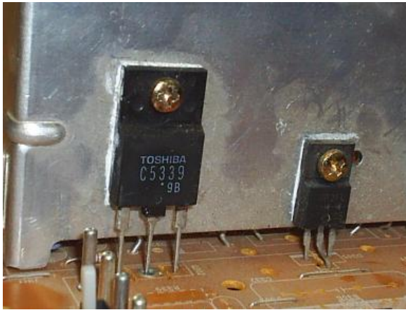
Figura 16: Componente montate pe radiator și ventilator pentru răcirea radiatorului
